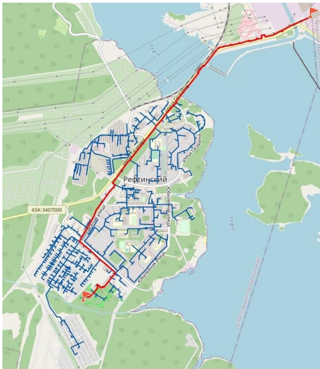
Рисунок 3.17. Путь построения пьезометрического графика пгт. Рефтинский, от Рефтинской ГРЭС до 5 эт 5 сек в перспективных вариантах
