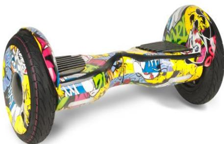
Гироскутер – электрическое средство передвижения в форме поперечной планки с двумя колесами по бокам, не имеет рулевого столба. Стоя двумя ногами на поперечной планке, человек управляет его движением, балансируя и перемещая массу своего тела в необходимую сторону.
